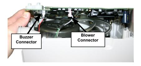
FIGURE F: LOCATION OF BLOWER CABLE CONNECTOR AND BUZZER CONNECTOR
